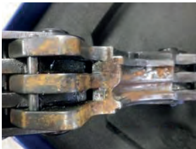
Figura 17 - Esempio di attrezzatura arrugginita
