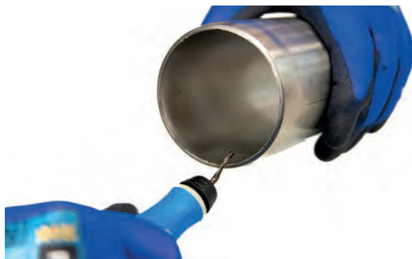
Figura 32 – Sbavatore manuale con lama adatta al materiale del tubo
