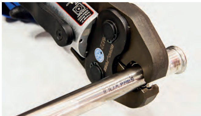
Figura 42 - Pressatura del raccordo
